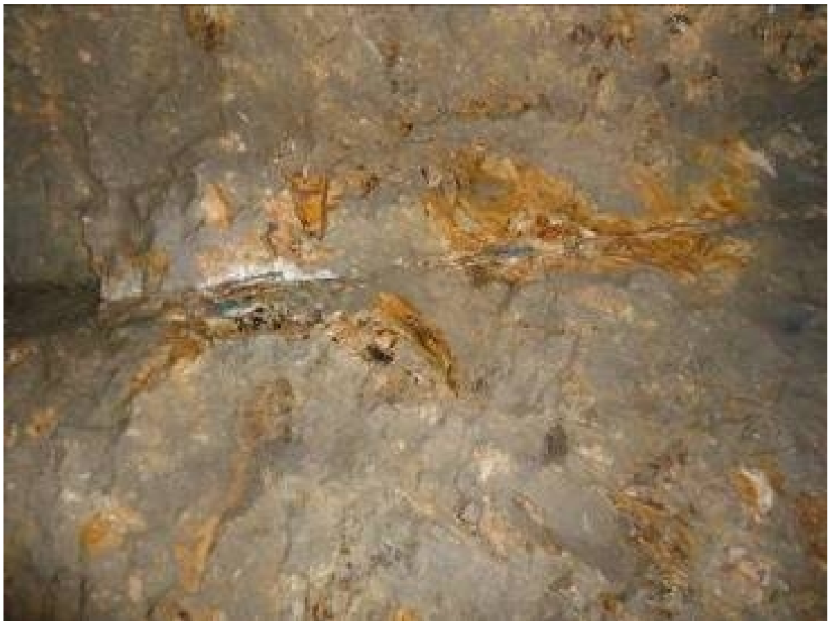
Fig. 7) Sul soffitto della galleria la frattura con direzione antiappenninica in corrispondenza della quale si sviluppa la mineralizzazione a solfuri argentiferi (tetraedrite) in ganga quarzosa
