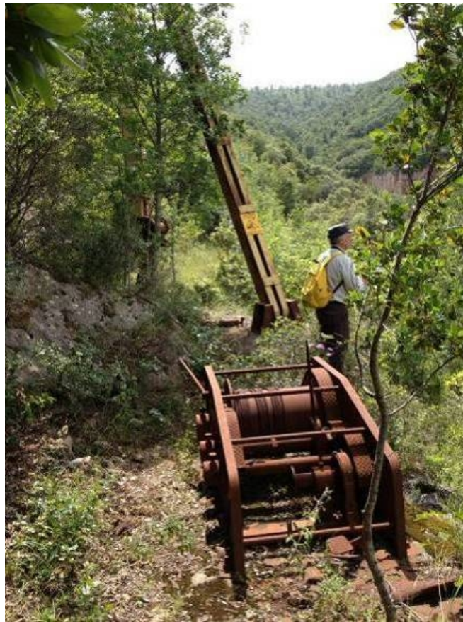
Fig. 12 In primo piano un argano e più in lontananza altre attrezzature utilizzate per la rimozione dei blocchi
