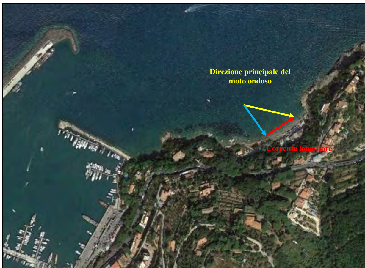
Figura 14 - Individuazione della direzione della corrente longshore nell'arenile Cantoniera
