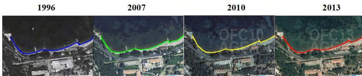
Figura 47 - Analisi diacronica della linea di costa fra il 1996 ed il 2013 del punto 6 - Spiaggia Soda - SP2
