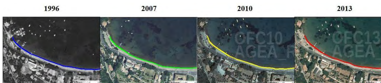
Figura 43 - Analisi diacronica della linea di costa fra il 1996 ed il 2013 del punto 5 - Spiaggia Pozzarello - SP3
