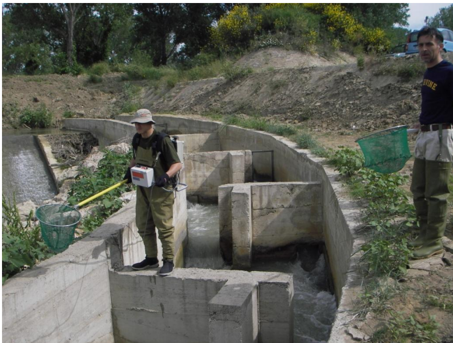
Figura 41 – Verifica di funzionalità del passaggio per pesci sul F. Ombrone, località Istia.
